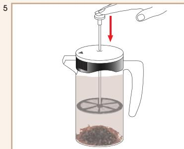
Filterstab langsam und mit leichtem Druck gerade und gleichmäßig nach unten drücken. Darauf achten, dass der Ausgießer von Personen weggerichtet ist.
